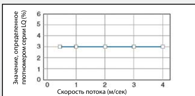
Микроволновое измерение сдвига фаз Так как заиливание и закristализованность не оказывают влияния на фазы, измерения гарантированно будут точными и надежными
