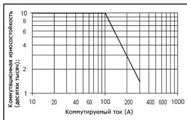
Рис. 14 – Коммутационный ресурс при коммутации конденсатора
