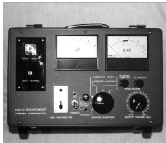
Рис. 11 – Компактный прибор Тошиба для измерения вакуума
