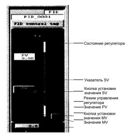
Рис. 3.26 ПИД-регулятор (PID)
