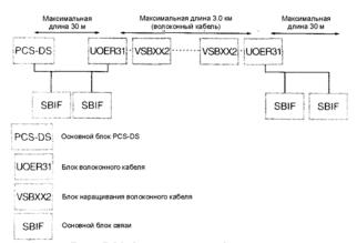
Рис. 5.20 Структура конфигурации последовательной шины (с использованием 1 каскада оптического ретранслятора)
