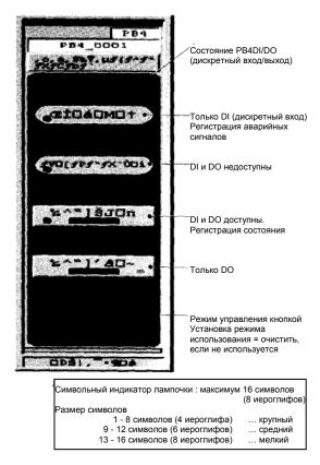
Рис. 3.42 Кнопочный переключатель на 4 точки (PB4)
