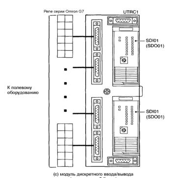
Рис. 5.12 Пример монтажа РІ/О модулей
