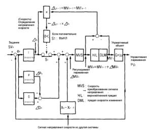
Рис. 5.26 Функциональная блок-схема PID-алгоритма внутренней последовательности (скорости)
