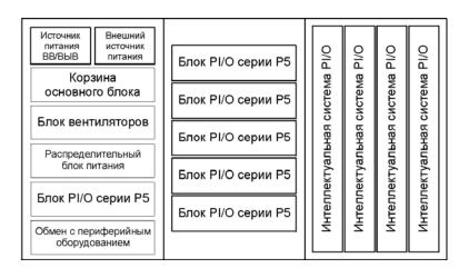
Рис. 5.8 Компоновка станции PCS-DS (пример)
