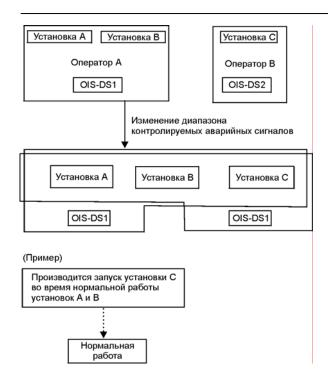
Рис. 3.22 Свободный выбор диапазона контролируемых аварийных сигналов
