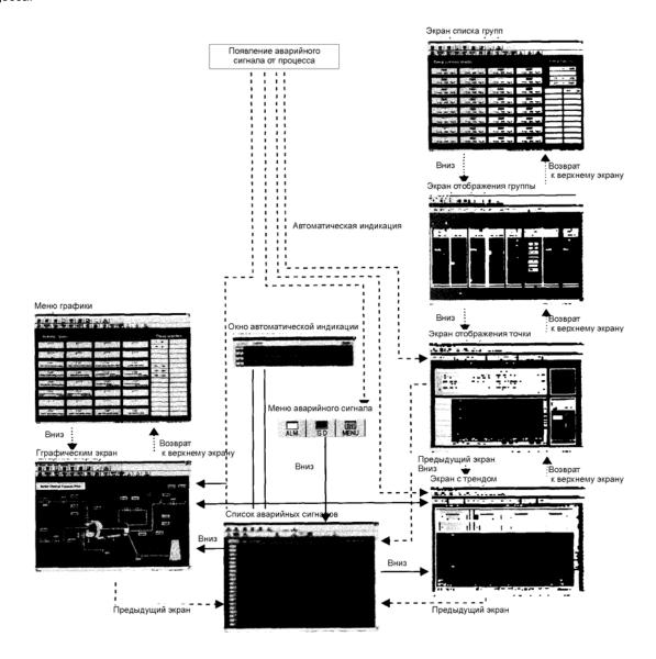
Рис. 3.54 Пример работы с экраном при появлении аварийного сигнала от технологического процесса
