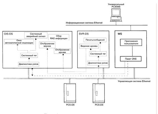
Рис. 2.6 Конфигурация системы с пакетом ONS
