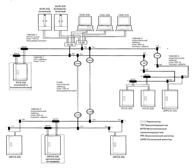
Рис. 2.2 Конфигурация сети, использующей 10M-Ethernet
