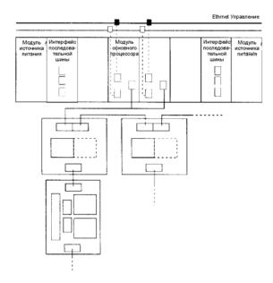
Рис. 5.32 Конфигурация PCS-DS с резервированием
