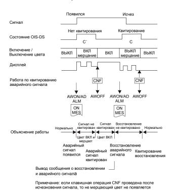
Рис.4.13 Обработка аварийного сигнала методом C
