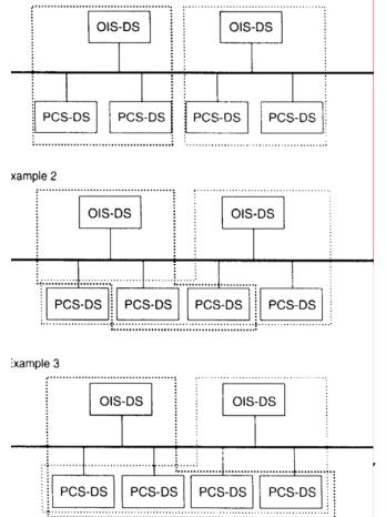
то при отказе одного из интерфейсов другой может продолжать обработку/управление.
