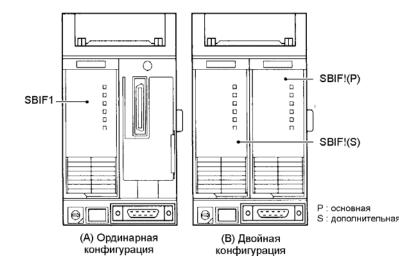
Рис. 5.11 Пример монтажа модуля связи
