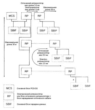
Рис. 5.22 Структура конфигурации последовательной шины (центром конфигурации является PCS)
