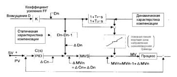
Рис. 5.28 Раздельное управление по упреждению и по обратной связи
