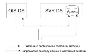
Рис. 4.5 Ведение архива состояния системы
