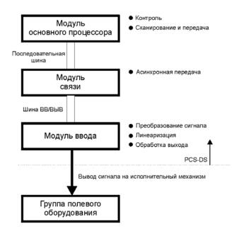
Рис. 5.24 Поток выходных данных
