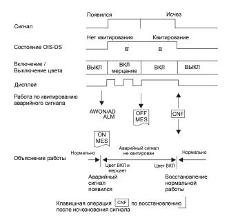
Рис.4.12 Обработка аварийного сигнала методом В
