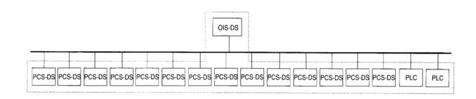
Рис. 3.51 Количество контроллеров PCS, управляемых или обслуживаемых интерфейсом оператора OIS-DS
