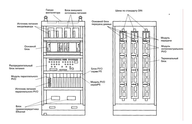
Рис. 5.7 Размещение типовых устройств
