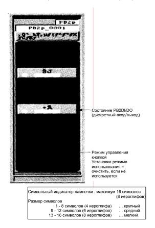
Рис. 3.42 Кнопочный переключатель на 2 точки (PB2)
