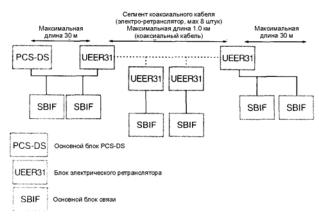
Рис. 5.19 Пример конфигурации системы PCS-DS с использованием электрических ретрансляторов
