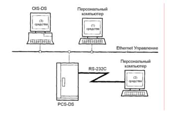
Рис. 1.6. Виды подключения
