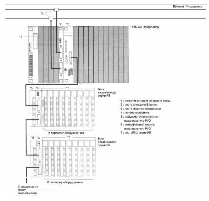
Рис. 5.5 Подсоединение сконфигурированной системы (параллельный ввод/вывод серии Р5)
