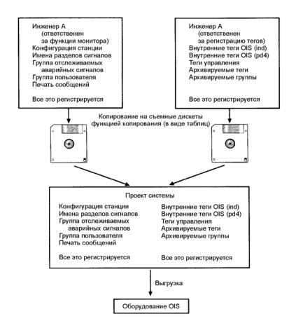
Рис. 6.19 Пример параллельной работы по проектированию с помощью функции копирования
