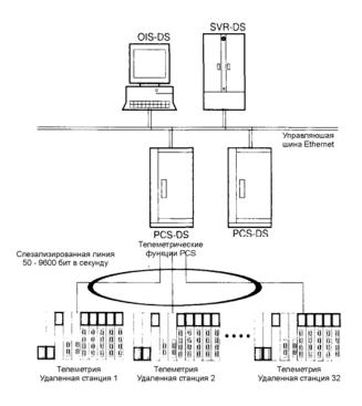
Рис. 2.5 Пример конфигурации телеметрической системы
