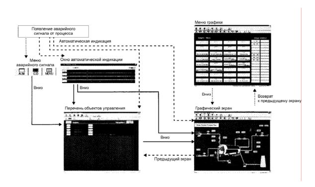
Рис. 3.55 Пример работы с экраном при появлении аварийного сигнала по управлению технологическим процессом
