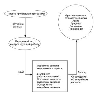
Рис.4.16 Обработка сигнала от внутреннего процесса и входного и выходного сигналов
