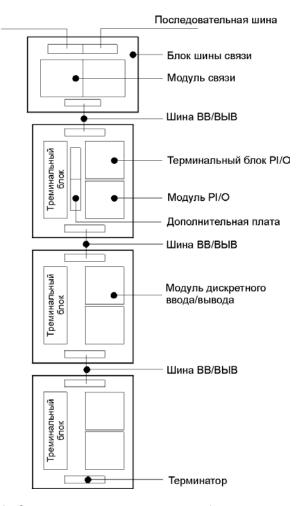
Рис. 5.14 Структурная схема шины ввода/вывода
