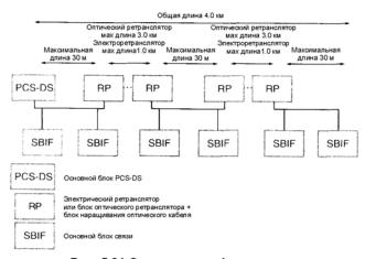
Рис. 5.21 Структура конфигурации последовательной шины (с использованием серии каскадов)
