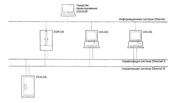
Рис.4.19 Пример подсоединения к информационной системе Ethernet
