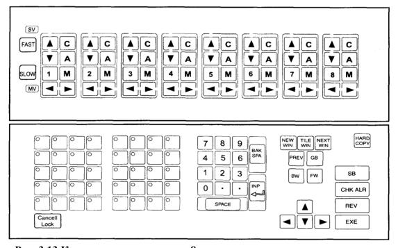
Рис. 3.13 Клавиатура оператора с 8-ю контурами управления
