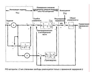
Рис. 5.25 Функциональная блок-схема PID-алгоритма с 2-мя степенями свободы
