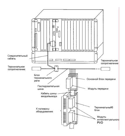
Рис. 5.6 Конфигурация системы (подключение интеллектуальных РІ/О)
