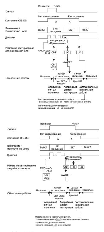
Рис.4.11 Обработка аварийного сигнала методом A
