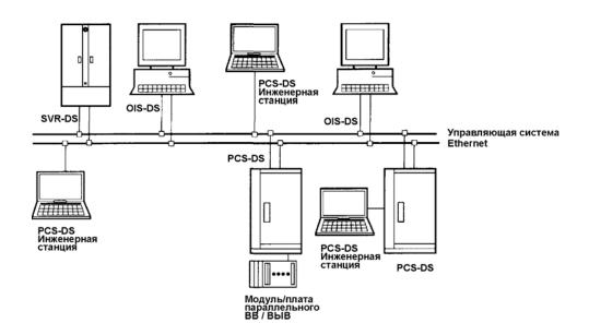
Рис.2.1 Конфигурация управляющей системы, соединенной управляющей системой Ethernet
