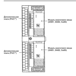
Рис. 5.13 Дополнительная плата
