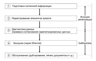
Рис. 6.11 Последовательность работ по проектированию
