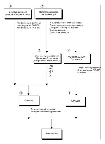
Рис. 6.2 Последовательность работ по проектированию
