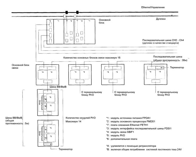
Рис. 5.9. Блок-схема интеллектуальной системы РІ/О
