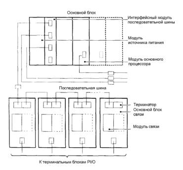
Рис. 5.15 Структурная схема шины последовательного доступа
