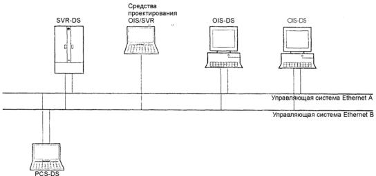
Рис.4.18 Пример подсоединения к управляющей системе Ethernet
