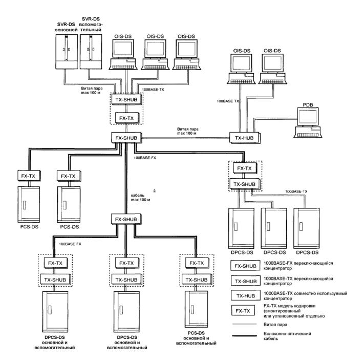
Рис. 2.3 Конфигурация сети, использующей 100M-Ethernet
