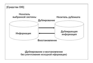
Рис. 6.20 Функции дублирования и восстановления
